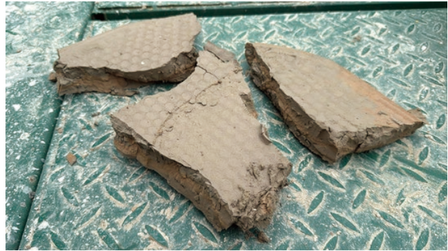
脫水後的污泥「泥餅」
