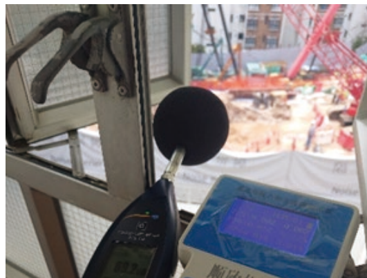
在居民家中進行噪音測量
